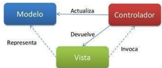
Figura. 1: Funcionamiento del patrón de arquitectura MVC.
