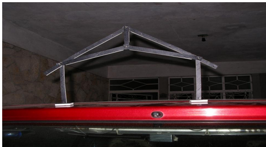
Fig. 10 Armadura soportada por dos columnas empotradas en sus apoyos
