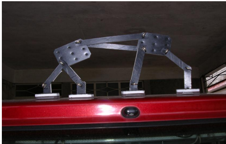
Fig.3 Unión de tres discos (dos paneles y una plancha metálica) mediante seis ligaduras y cuatro apoyos de articulación fija.
