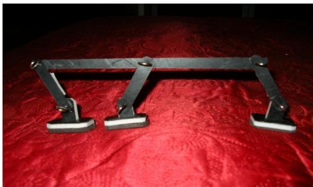
Fig. 1 Unión de dos discos mediante tres ligaduras no concurrentes ni paralelas entre si y tres apoyos de articulación fija.
