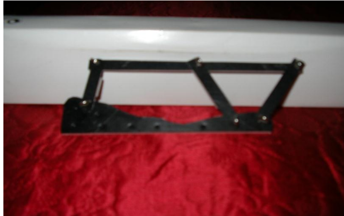
Fig. 2 Unión de dos discos mediante tres ligaduras no concurrentes ni paralelas entre sí.
